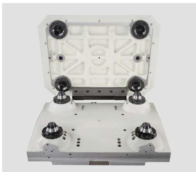
Базирование и фиксация по четырем опорным элементам со специальными уплотнениями.
