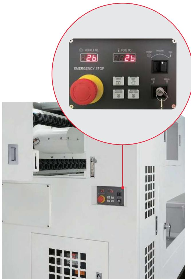
**ПУЛЬТ УПРАВЛЕНИЯ\*** и дверца магазина находятся на задней стороне станка, что позволяет загружать, выгружать и проверять инструмент во время работы. Вызов инструмента производится по его номеру или по номеру ячейки. При ручном управлении станок не прекращает работу в ожидании закрытия дверцы магазина и перевода переключателя в положение, соответствующее автоматическому режиму работы.
