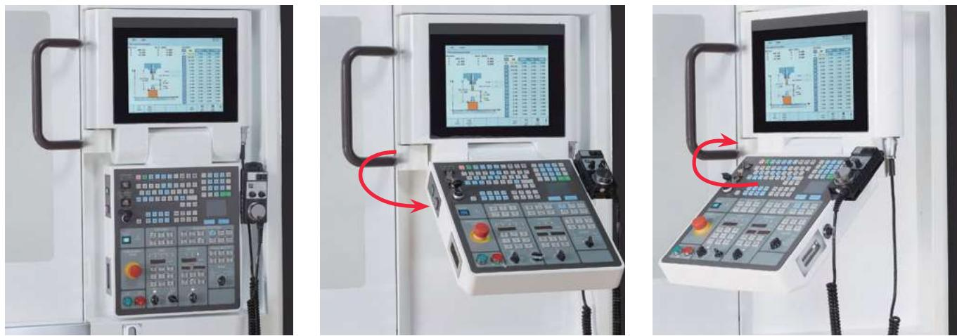
Положение пульта управления можно регулировать по двум осям – можно изменять его угол наклона и поворота.
