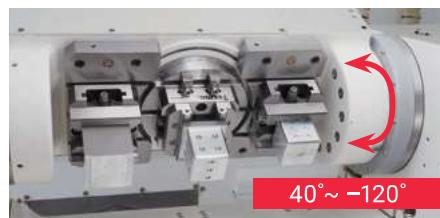
Угол наклона оси стола
