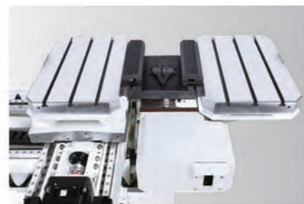
伺服驅動交換工作台 工作台交換時間: 8.5秒。
