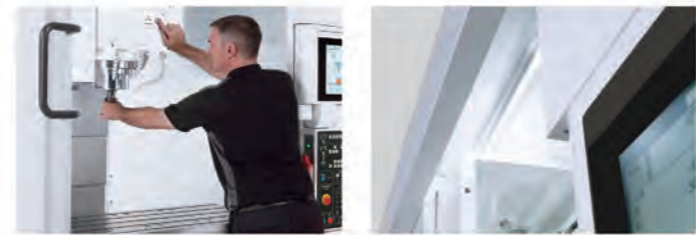
3. 縮短主軸安裝刀具距離
