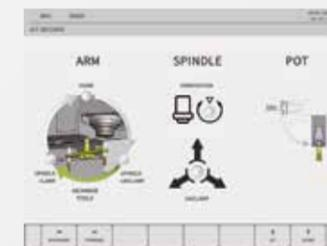
刀庫(ATC)重置設定 讓操作者依照圖形引導，重置自動換刀系統回原點。
