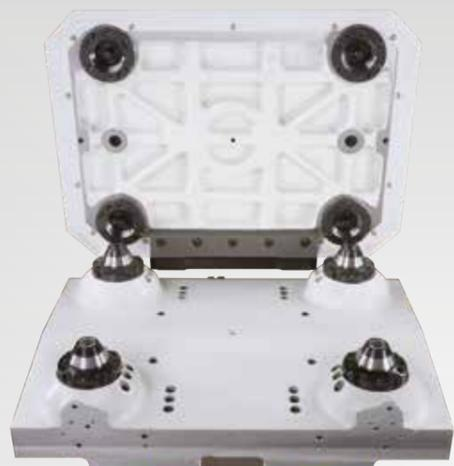
工作台以高精密錐度孔夾持，搭配壓力檢測系統，確保最佳運轉精度。
