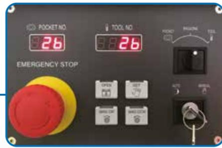
刀庫操作面板\*及刀庫後門，讓操作者在機器於自動加工運轉之狀態下，能同時從機器後方取刀、掛刀或檢驗刀具。操作者可以依需求直接呼叫「刀具號碼」或「刀杯號碼」，簡便而容易。當刀庫門處於打開的狀態下，若自動執行程式判讀到任何換刀指令或刀庫移動指令，則機器之動作將單節暫停，直到刀庫門關上後並按啟動鍵，程式才會繼續。
