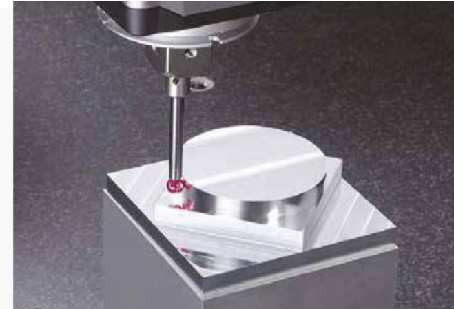
如左圖之測試工件，每一台美克迪® 機器以進給率 2 m/min 的速度實際切削並檢驗真圓度、直角度及平行度，所有項目標準必須達到 5 μm 以內。
