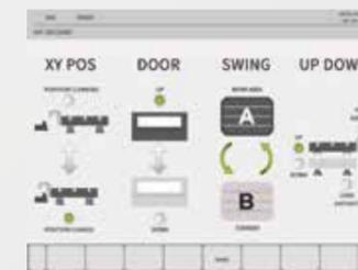
工作台(APC)重置設定 讓操作者依照圖形引導，重置自動換刀系統回原點。
